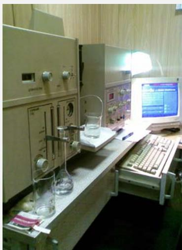
Атомно-абсорбционный спектрометр с пламенной атомизацией «КВАНТ ЭФА» ООО «КОРТЕК»
